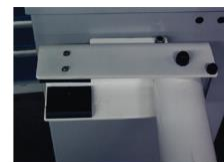
Puomivarren murtonivel Törmäyksestä hajoava puomivarren kiinnitys
